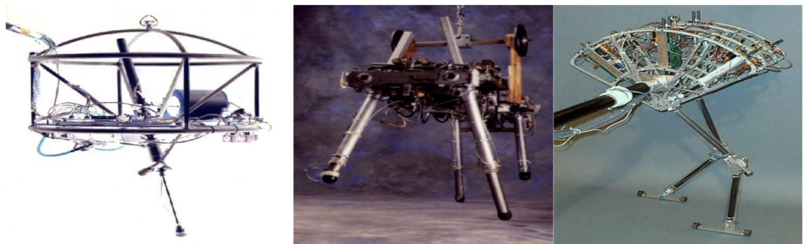
1.2 Сурет – Бір аяқты секіретін робот (а), желе жортып жүгіретін төрт аяқты робот (б), және екі аяқты «Серпімді фламинго» роботы (Spring Flamingo) (в)
